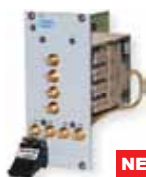
40-884 6GHz 4x4 Matrix SMA 50Ohm
